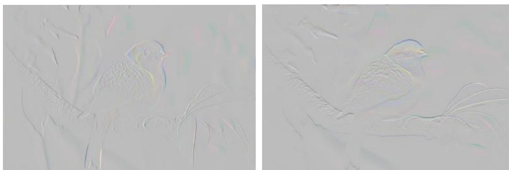
Obrázek 10 - algoritmy Sobel operátor s vertikální a horizontální maskou
